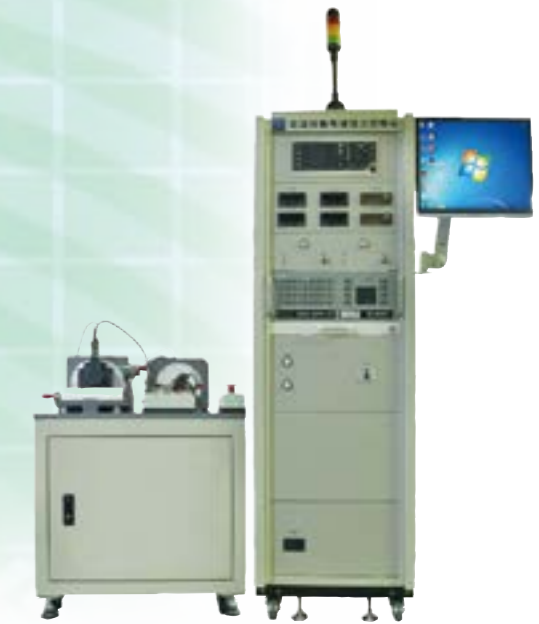
交流伺服馬達扭力測試設備 AC Servo Motor Torque Test Equipment
