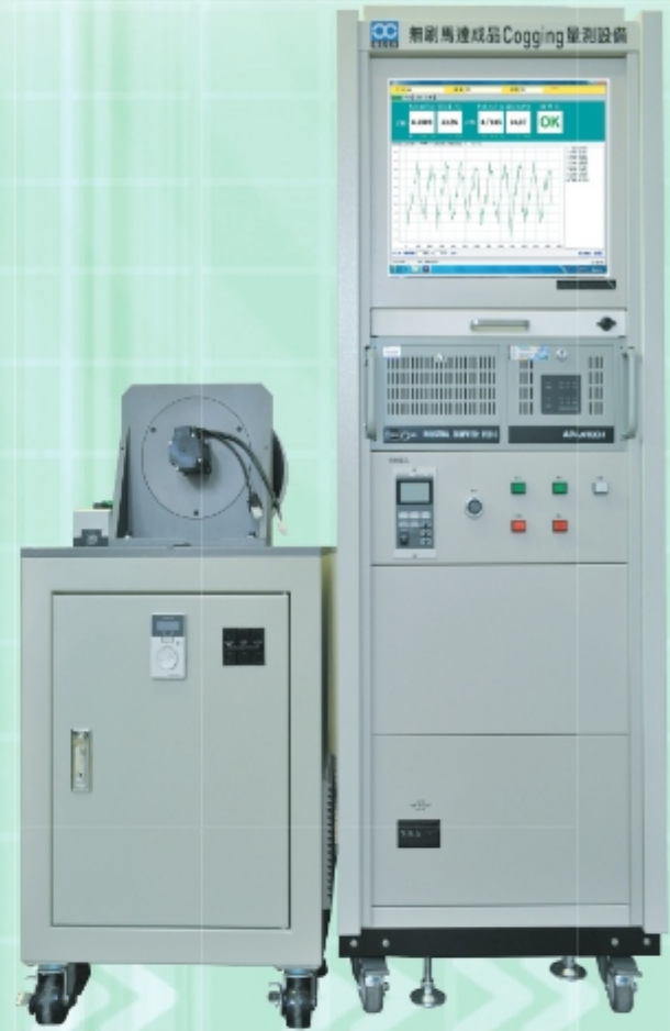
無刷直流馬達Cogging Torque測試設備 BLDC Motor Cogging Torque Test Equipment
