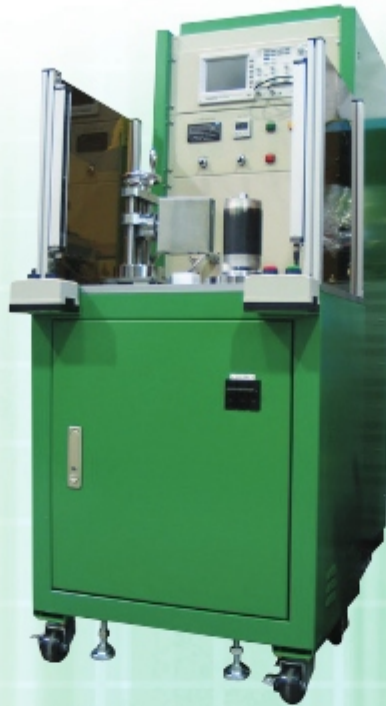
斷槽測試設備 Rotor Test Equipment
