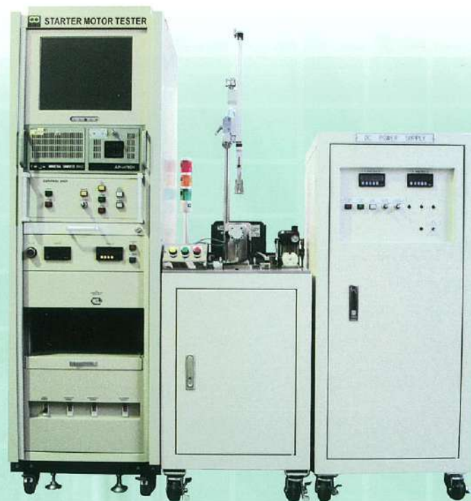
起動馬達特性測試設備 スターティングモーター(starting motor)特性測定設備
