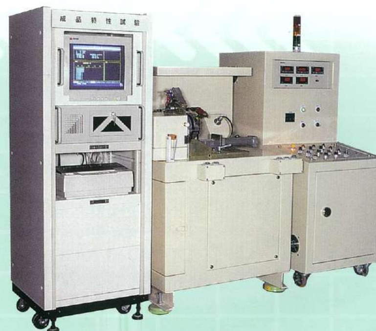
汽車交流發電機特性測試設備 自動車用のAC發電機特性試驗裝置
