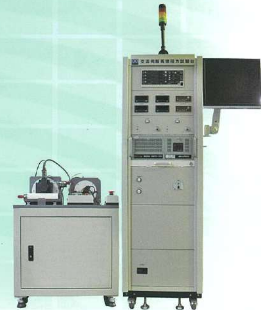
交流伺服馬達扭力測試設備 交流サーボモーター(servo motor) トルク試驗裝置
