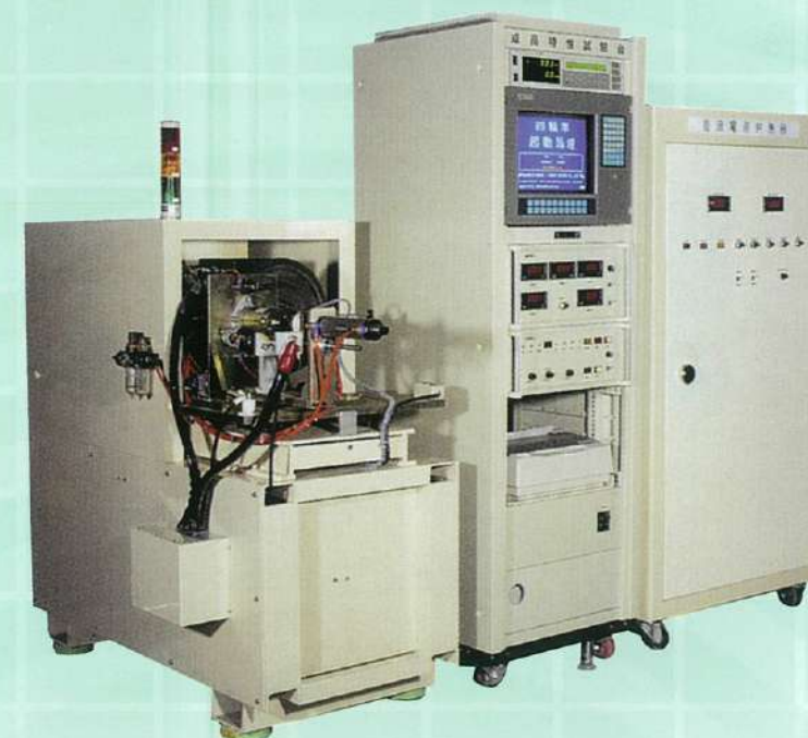
汽車起動馬達特性測試設備 自動車用のスターティングモーター(starting motor)特性試験装置
